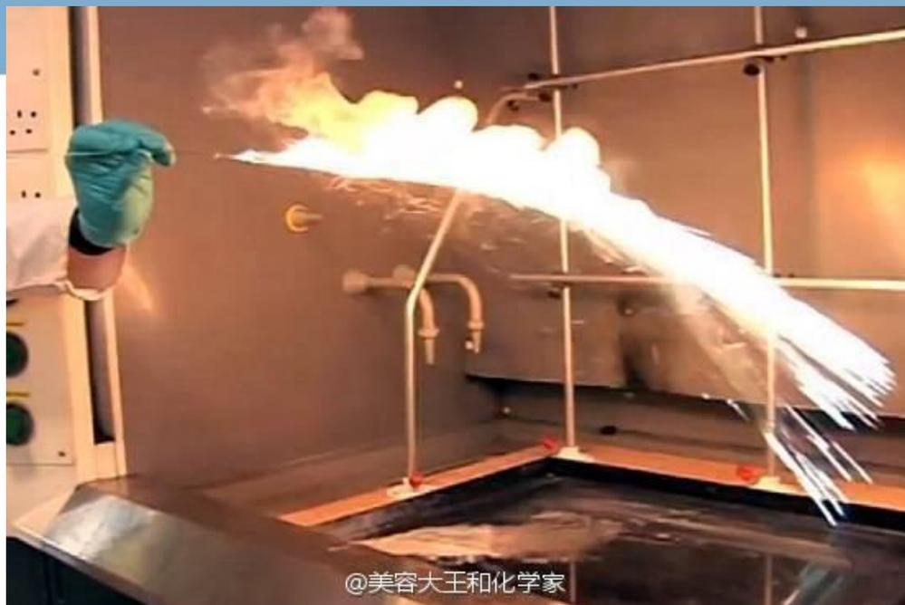
金属罐口是黄铜的三通阀门，取样之前先通氮气吹着，注射器也要来回拉几次把里面的空气换成氮气，然后把阀门打开，针尖插进去取样。但是拔出来的时候有可能会闪几下火星，因为针尖部分会接触到空气。因此,还有一种办法就是直接插一条空心针，一头通叔丁基锂，一头通反应的烧瓶，不过不容易定量。
